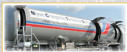
当社グループでは全国の複数拠点に実物大の「LNG車両カットモデル」を配置し、NCTS教材として活用しています。実物大のLNG車両カットモデルの製作は、おそらく世界で初めてとなる試みであり、タンク側面に開放口をつけることで断面や内部の構造が分かる仕様となっています。実際にタンク内に入ることも可能であり、ガスラインや液面計ラインなどの圧力容器の仕組みについて、理解の深度化を図っています。
