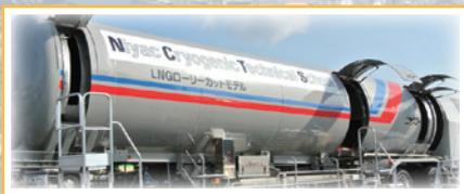
也许是世界范围内的首创，荷役已经建造了一台液化天然气槽车的“剖视”模型，学员们可以窥视车辆内部以直接理解气体的流动和操作方式。也就是说、透过设备的外部构造进行观察并亲手检查其内部纹理、他们可以获得新的视角和更深入的知识。
